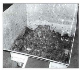
Das separierte Koagulat ist spatentrocken und sofort deponiefähig; eine nachträgliche Schlammentwässerung entfällt.
