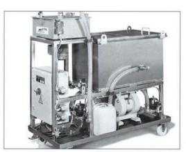
Durch den Einsatz hochwertiger Edelstähle und besonderer Dichtungswerkstoffe sind die Anlagensysteme auch für extrem aggressive Medien geeignet.
