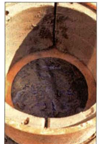
Der separierte Schlamm liegt stichfest vor. Durch das minimale Gewicht können Anwender die Entsorgungskosten einsparen.
